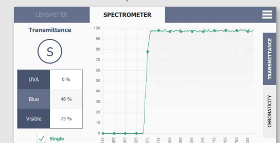
UV-A, blaues und sichtbares Licht mit Transmissions-Prozentangaben
